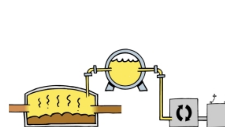
Biogas fra rådnetank til gasgeneratorer Biogas from digester to gas motor generators
